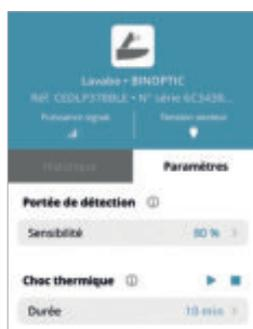
La **distance de détection** est paramétrable en ajustant la sensibilité du capteur à l'environnement du sanitaire (position, hauteur de la vasque, etc.)
