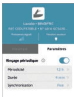
Le **rinçage périodique** est une purge des canalisations pour éviter le développement des bactéries. Il est possible de choisir :
