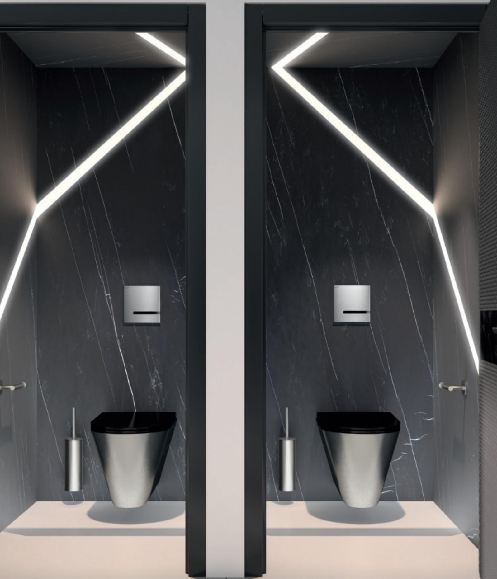
Bâti-support TEMPOFIX 3 avec système de chasse d'eau directe automatique TEMPOMATIC Connect **564005BE + 465000** - WC suspendu S21 S **110310**
