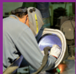
Soudure sur sanitaire Inox Usine DELABIE d'Aveiro au Portugal
