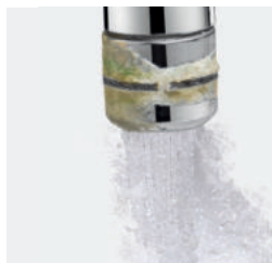
Straal met verkalkte perlator: spatten
