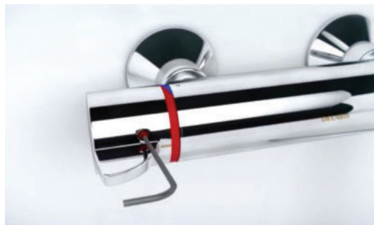
Temperatuurbegrenzing deblokkeren om een thermische spoeling uit te voeren: eenvoudig de rode stip indrukken met een scherp voorwerp.
